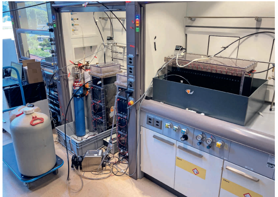
Fig. 2 Die zwei MEC-Fermenter-Typen. Der liegende Reaktor A (r.) und der Säulenreaktor B in der Bildmitte.
