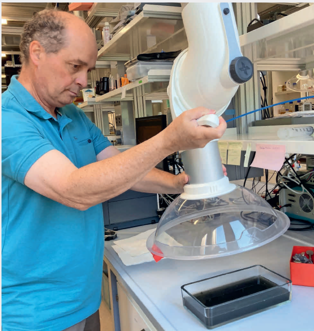
Fig. 6 Fabian Fischer bedeckt eine Klärschlammprobe aus der ARA Châteauneuf mit einem Dunstabzug, um die Geruchsbelästigung zu vermindern. Der Klärschlamm mit einem Feststoffanteil von ca. 3% wird in der Mikrobiellen Elektrolysezelle mit hohem Wirkungsgrad in Methan umgesetzt.
